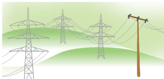
Der erzeugte Strom wird ins **Stromnetz** eingespeist. Von 380.000-Volt-Höchstspannungsleitungen über 110.000-Volt-Hochspannungsleitungen bis zu 20.000-Volt-Mittelspannungsleitungen wird er immer weiter verzweigt und verteilt.
